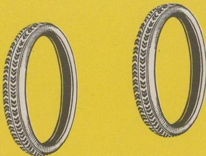
Wichtig für Fahrkomfort und Federung des gesamten Fahrzeuges sind die Reifen. Die Spezial-Super-Ballon-Reifen 23" x 2,25" mit verstärktem Profil schlucken die meisten Stöße noch ehe sie auf Schwingen, Rahmen und Sattel wirken.
