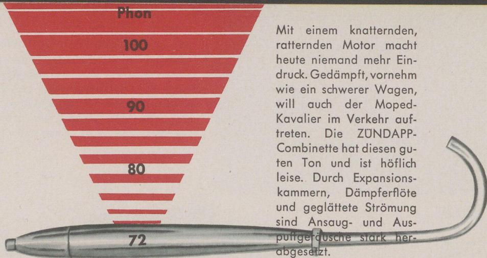
Mit einem knatternden, ratternden Motor macht heute niemand mehr Eindruck. Gedämpft, vornehm wie ein schwerer Wagen, will auch der Moped-Kavalier im Verkehr auftreten. Die ZÜNDAPP-Combinette hat diesen guten Ton und ist höflich leise. Durch Expansionskammern, Dämpferflöte und geglättete Strömung sind Ansaug- und Auspuffgeräusche stark herabgesetzt.
