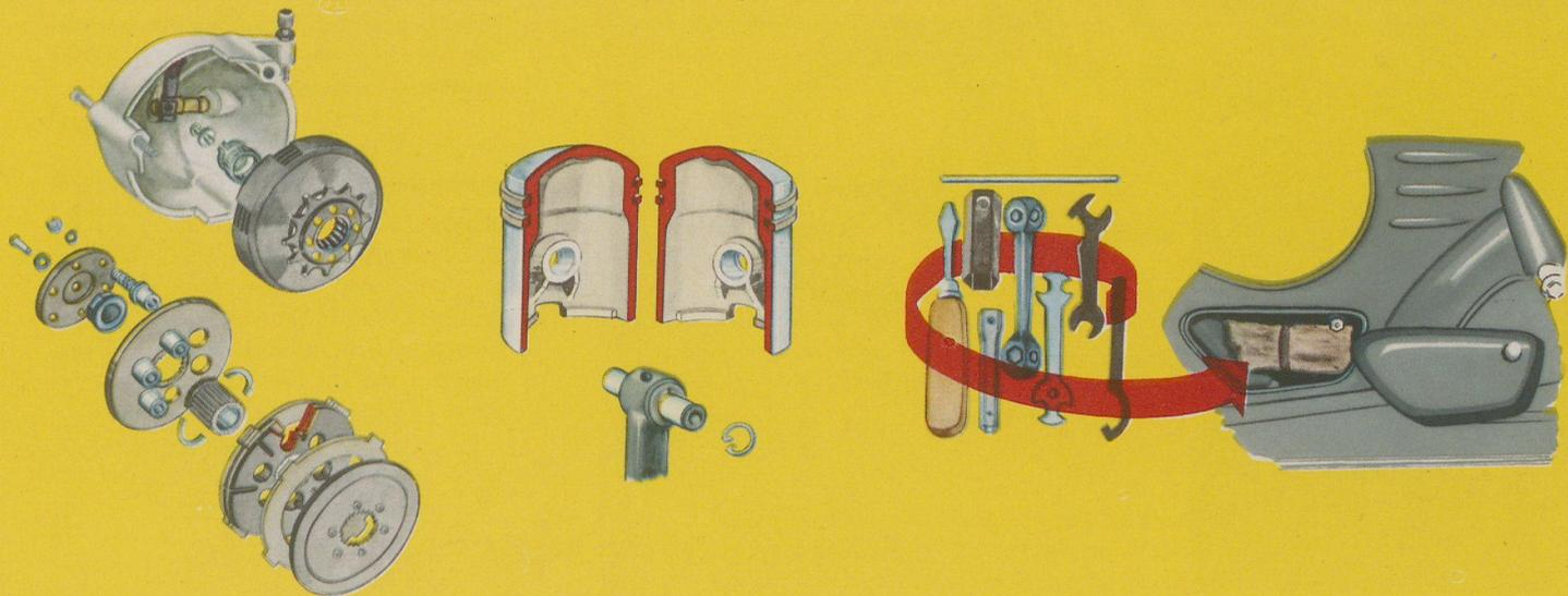
Die 3-Scheiben-Trockenkupplung ist eine vollwertige Motorrad-Anfahrkupplung und vermittelt weiches, sicheres Anfahren aus dem Stand, auch am Berg. Sie ist in hohem Grad temperaturfest und ohne Demontage des Motors leicht zugänglich. Das ist wichtig — auch für den Geldbeutel.
