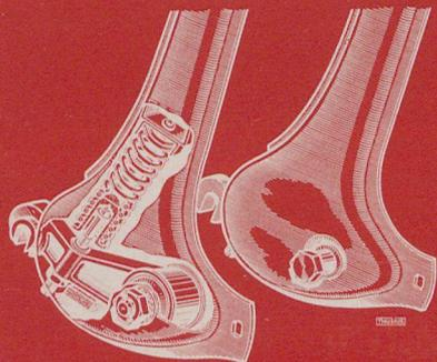
Durch das Zusammenwirken von Vorder- und Hinterradschwinge, Schwingsattel und Super-Ballon-Reifen wird eine ungewöhnlich gute Federungseigenschaft erzielt. Durch richtiges Einstellen von Vorderradschwinge, Schwingsattel und Reifendruck kann jeder ein Optimum an Federung erreichen. Das Fahren auf der Combiette S ist ein Genuß.
